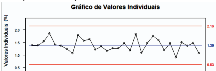
Figura 11: Gráficos de controle da média da umidade da mistura do pó para compressão
